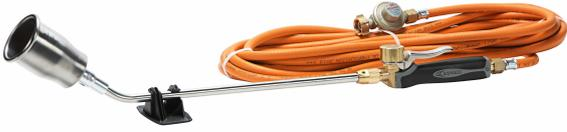
Composé : 1 godet inox Ø 60 mm/puissance : 102 kW (réf. 100S) 1 col 400 mm (réf. L400) 1 manche à gachette bimatière à raccord tournant entrée 3/8e gauche / filetage raccordement lance M18 x 1 mâle ( réf. 620) 1 tuyau caoutchouc de 10 m avec raccords sertis 3/8e gauche femelle / Ø int. 6,3 m (réf.963/10) 1 détendeur propane 4 bars sortie 3/8e gauche / entrée écrou bouteille à ailettes (21,8 x 1,814) à gauche (réf. 684).
