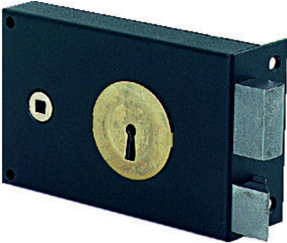
Clés 4 Gorges en acier nickelé - 24 variures pour grilles, portails ou portillons fonction équerre axe : 56 mm - entraxe : 57 mm finition : peinture époxy noire carré : 6 mm pêne 1/2 tour : acier zingué, saillie 21 mm pêne dormant : acier zingué, course : 28 mm canons : 40 mm livrée avec gâche et vis de fixation, 2 clés (série A ou B).
